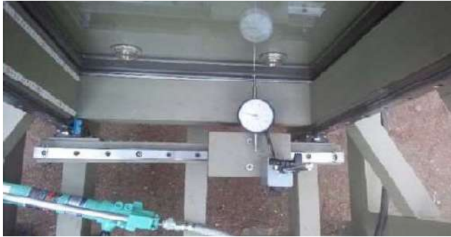
ダイヤルゲージ (アクリル変位量を計測)
