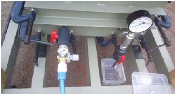
水用レギュレーター (水量の制御) 水圧計 (水圧の測定)
