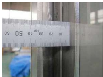
透明樹脂板とステンレス外枠縁の寸法が 28mm～29mm であることを確認する。
