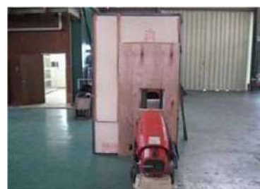
装置全体 側面 断熱ボックスで覆った状態
