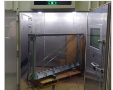
試験体 (恒温恒湿室を使用した試験)
