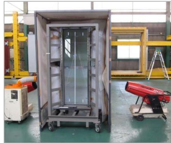
試験体 (ジェットヒーターによる試験)
